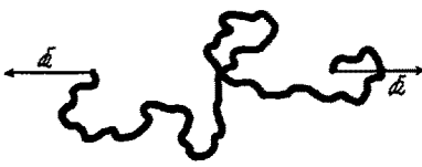
Abb. 4. Um die Fadenenden des Systems Abb. 2 auf der x -Achse in einem Abstände h festzuhalten, muß auf die Fadenenden je eine Kraft \mathfrak{R} von dem in Gleichung (3) angegebenen Betrage in der Pfeilrichtung ausgeübt werden.
