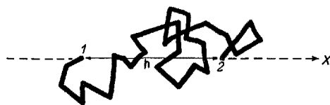
Abb. 2. Statistisch gestaltetes Molekül, dessen Anfangs- und Endpunkt sich auf der x -Achse befinden.
